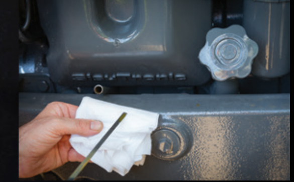
Eğimli kaporta ve ön aks tasarımı, motor yağ filtrelerine ve yağ çubuğuna rahat erişim sağlar.
