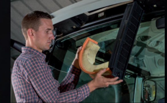
Kabin hava filtresi, temizlik için kolaylıkla çıkarılabilir.
