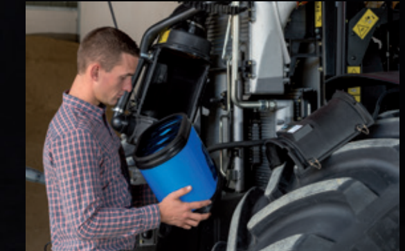
Düzenli ölçülandırılmış soğutma ünitesinin erişimi, temizliği ve bakımı kolaydır. Soğutma fanının emişi sayesinde tozun %90'ı temizlenir. Motor hava filtresinin erişimi ve temizliği de çok kolaydır.
